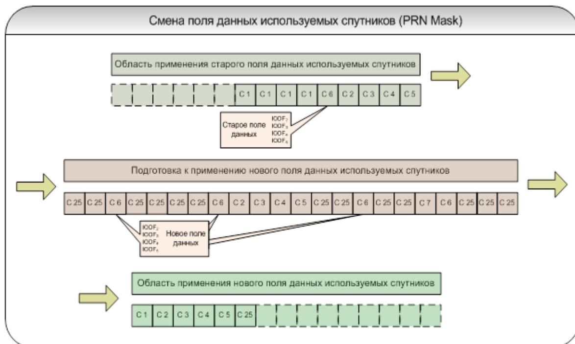
Рисунок Ж.1 – Схема передачи сообщений СДКМ при смене поля данных используемых спутников.
